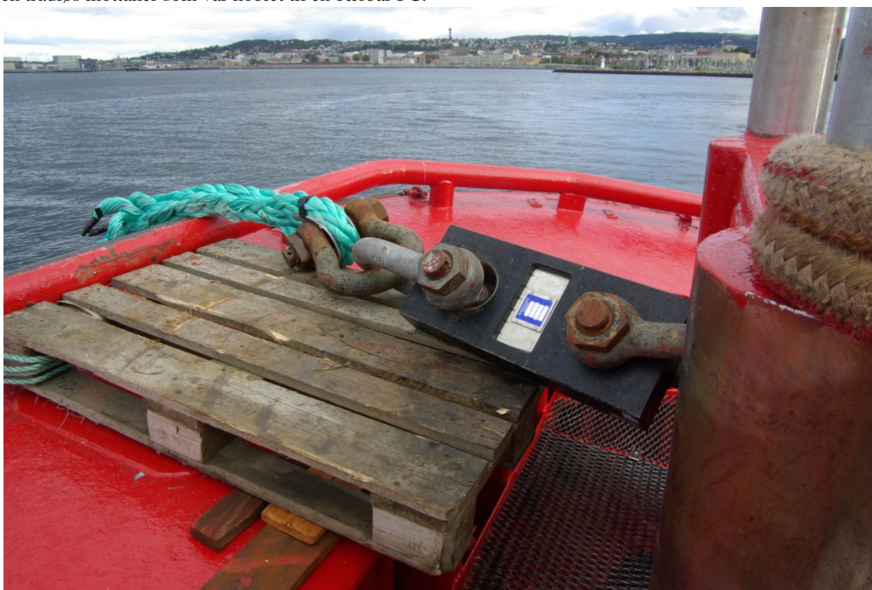
Figur 4. Straightpoint lastcelle montert til ankerrosse- Lastcellen hvilte horisontalt på en pall da den ikke var i bruk.
